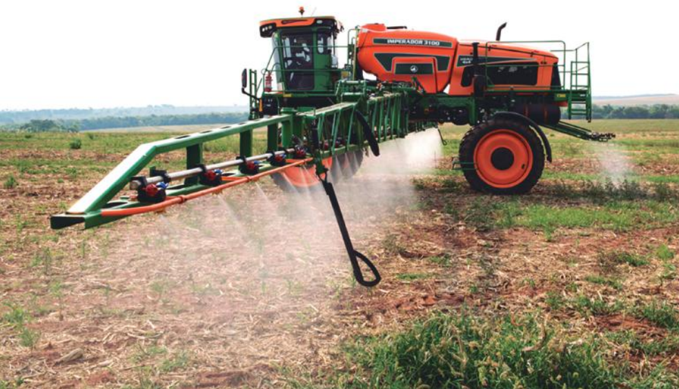
Aplicação de agrotóxico com pulverizador de barra
